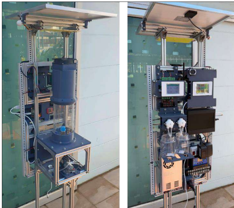
รูปที่ 5 แสดงต้นแบบโฟไตรแอคเตอร์อัตโนมัติสำหรับการดักจับคาร์บอนด้วยสาหร่ายคลอเรลล่า
