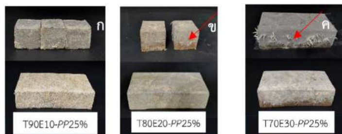
รูปที่ 3 แสดงโฟมชีวภาพต้นแบบจากกากชา (T) ผสมเปลือกไข่บด (E) ที่ระดับ (ก) 10% (ข) 20% และ (ค) 30%
