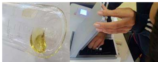
จากนั้นสารสกัดที่ได้จะถูกแยกออกเพื่อแยกน้ำมันหอมระเหย และวิเคราะห์สารประกอบที่สกัดได้โดยใช้สเปกโตรมิเตอร์เพื่อ เปรียบเทียบข้อมูลสเปกตรัม
