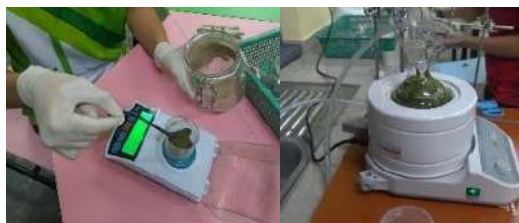
แยกใบโหระพาแห้งโดยใช้เครื่องกลั่นด้วยไอน้ำ ในอัตราส่วน 30 กรัม:100 มล. (ใบโหระพา : น้ำกลั่น)
