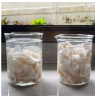
4. แช่เปลือกหอยใน 10% v/v H_2O_2 3 ชั่วโมง เพื่อกำจัดสารอินทรีย์ที่เหลือจากการ สลายโปรตีน และฆ่าเชื้อจุลินทรีย์
