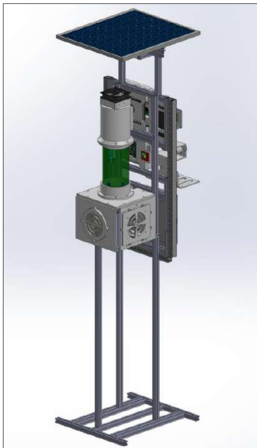
รูปที่ 4 แสดงการออกแบบโฟโตรีแอคเตอร์อัตโนมัติสำหรับการดักจับคาร์บอนด้วยสาหร่ายคลอเรลล่า
