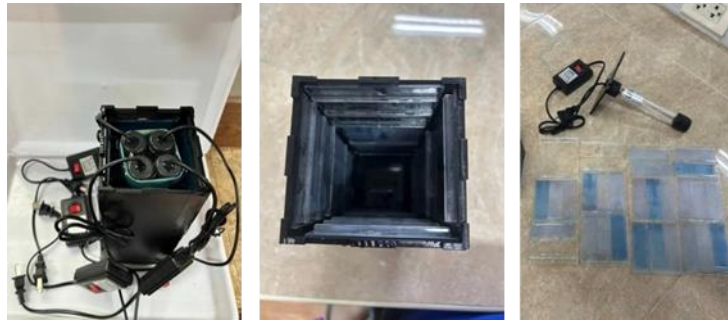
รูปที่ 5 การบำบัดน้ำปนเปื้อนสีครามโดยอุปกรณ์ต้นแบบ
