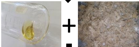
แยกเส้นใยและเลือกเส้นใยที่มีความยาวตามต้องการ ตัดเส้นใยเพื่อเพิ่มความแข็งแรง
