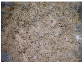
แยกเส้นใยและเลือกเส้นใยที่มีความยาวตามต้องการ ตัดเส้นใยเพื่อเพิ่มความแข็งแรง
