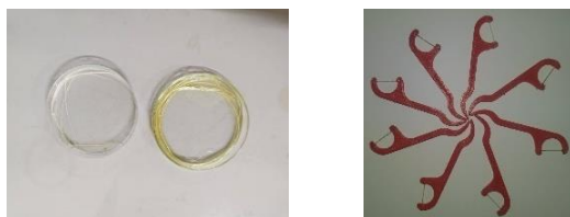
แช่เส้นใยที่เตรียมไว้ในสารสกัดจากใบโหระพาเป็น เวลา 24 ชั่วโมง และนำมาขึ้นรูปเป็นไหมขัดฟัน
