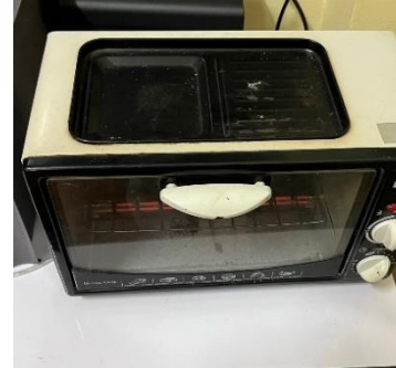
3. อบเปลือกหอยที่อุณหภูมิ 250 องศา เซลเซียส 2 ชั่วโมง เพื่อกำจัดชั้นโปรตีน
