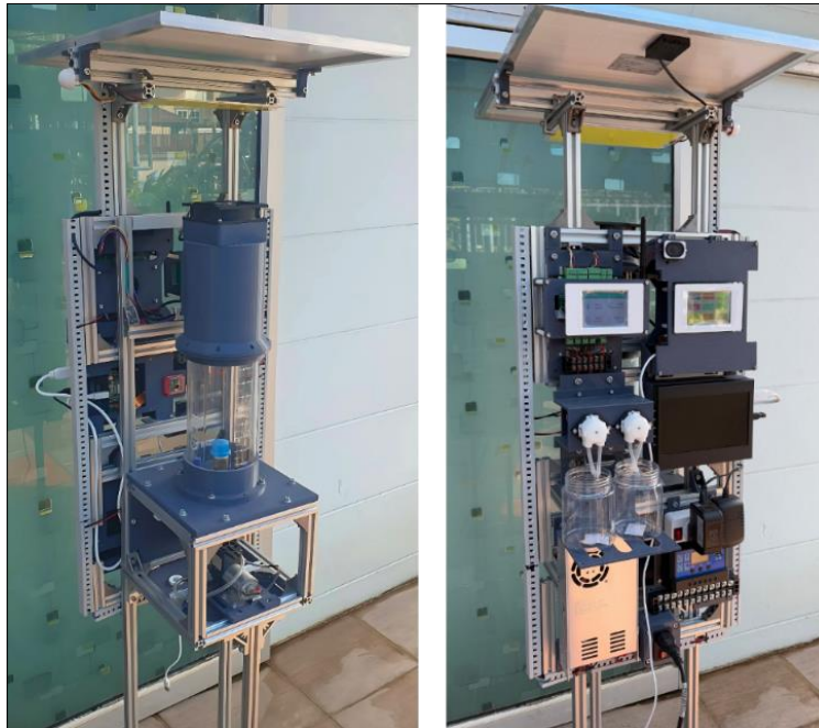
รูปที่ 5 แสดงต้นแบบโฟโตรีแอคเตอร์อัตโนมัติสำหรับการดักจับคาร์บอนด้วยสาหร่ายคลอเรลล่า
