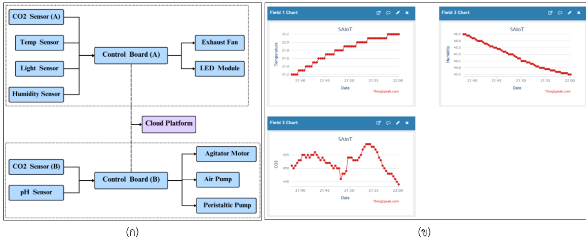
รูปที่ 6 แสดง (ก) แผนผังการทำงานชุดควบคุมโพโตรีแอคเตอร์และ (ข) โปรแกรมแสดงค่าเซนเซอร์บนอิงสปีค
