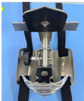
รูปที่ 8 แสดงยึดแผ่นยางปะเก็นเข้ากับชุดหัวหุ่น
