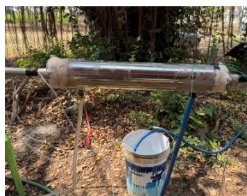
(ข) อุปกรณ์แลกเปลี่ยนความร้อนด้วยน้ำหล่อเย็นแบบหมุนวนที่พัฒนาขึ้น
