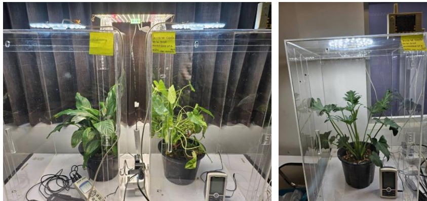
รูปที่ 1 การเก็บตัวอย่าง CO 2 ด้วยเครื่องบันทึกข้อมูลแบบมัลติมิเตอร์ (Multimeter Data Logger Lutron)
