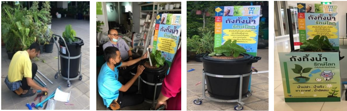
รูปที่ 2 แสดงการเจาะฝาลังเพื่อใส่กระถางต้นไม้ และการติดตั้งท่อน้ำทิ้ง
