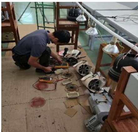
รูปภาพที่ 25 แสดงการตรวจวัดขดลวดมอเตอร์หลังอบ
