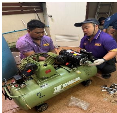
รูปที่ 27 แสดงการประกอบชุดมอเตอร์เข้ากับปั๊มลม
