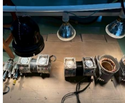
รูปที่ 24 แสดงการอบขดลวดมอเตอร์
