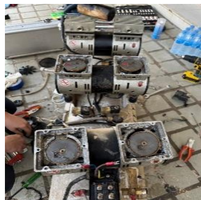
รูปที่ 16 แสดงการถอดมอเตอร์ปั๊มลมและล้างทำความสะอาด
