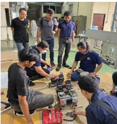
รูปที่ 21 แสดงการเตรียมชุดมอเตอร์เพื่อทำการอบ
