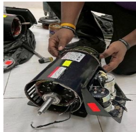
รูปภาพที่ 26 แสดงการตรวจวัดขดลวดมอเตอร์หลังอบ
