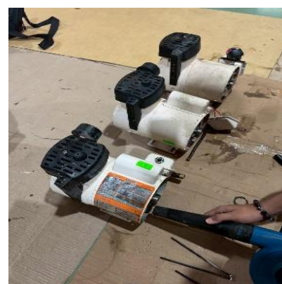
รูปที่ 22 แสดงการเตรียมชุดมอเตอร์เพื่อทำการอบ
