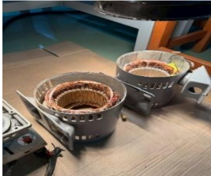
รูปที่ 23 แสดงการอบขดลวดมอเตอร์
