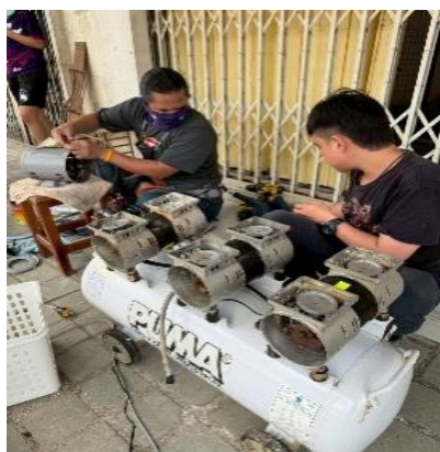
รูปที่ 15 แสดงการถอดมอเตอร์ปั๊มลมและล้างทำความสะอาด
