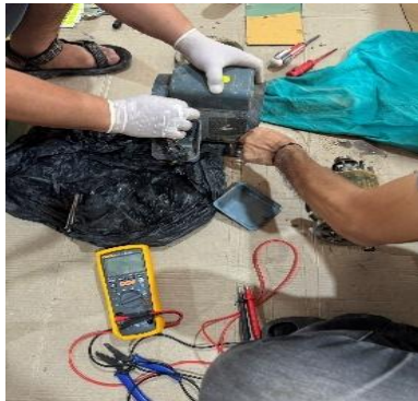
รูปที่ 17 แสดงการตรวจเช็คชุดลดมอเตอร์
