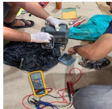
รูปที่ 18 แสดงการตรวจเช็คชุดลดมอเตอร์
