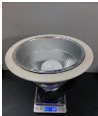
รูปที่ 6 แสดงการทดสอบชั่งน้ำหนักโคมไฟก่อนติดตั้ง
