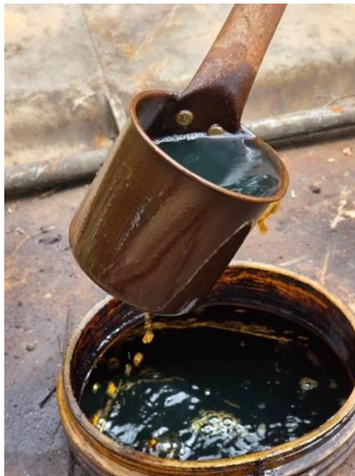
รูปที่ 3 ลักษณะทางกายภาพของน้ำมันไพโรไลซิสดิบ (Pyro-1) ที่ผลิตได้จากระบบเตาปฏิกรณ์
