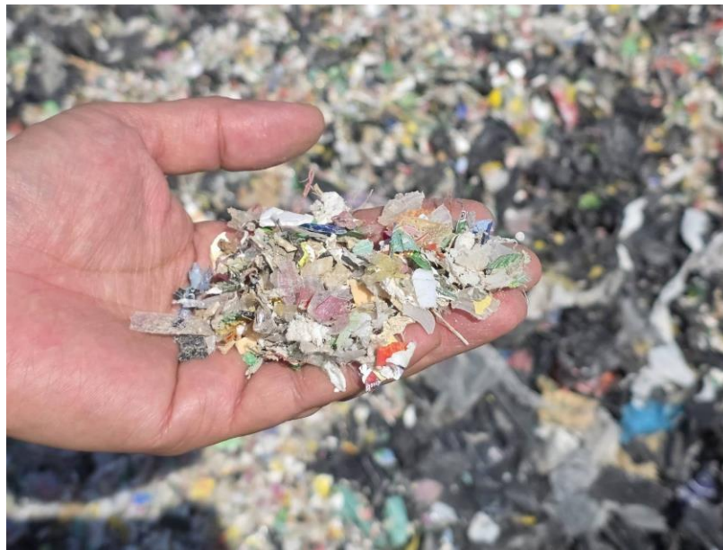
รูปที่ 1 ลักษณะทางกายภาพของขยะพลาสติกกรวมหลังกระบวนการบดย่อย (ขนาด 1-3 เซนติเมตร)
