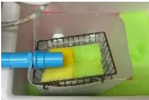
รูปที่ 2 ชุดถังกรองดักจับเศษปูน ครั้งที่ 1
