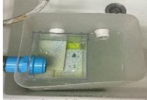
รูปที่ 7 แผ่นฟองน้ำระบายน้ำได้ดีและสามารถดักจับเศษปูนได้ดี
