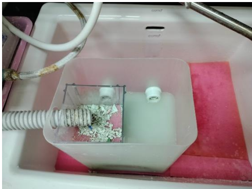
รูปที่ 8 ชุดถังกรองดักจับเศษปูน ครั้งที่ 4
