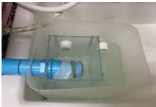
รูปที่ 4 ชุดถังกรองดักจับเศษปูน ครั้งที่ 2
