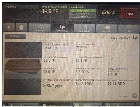
(ข) อัตราการไหลน้ำก่อนติดตั้งอินเวอร์เตอร์
